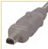
USB Mini 4-pin 6mm x 3mm
