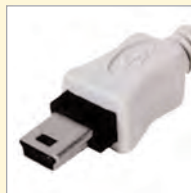
USB Mini 5-pin 4mm x 3mm
